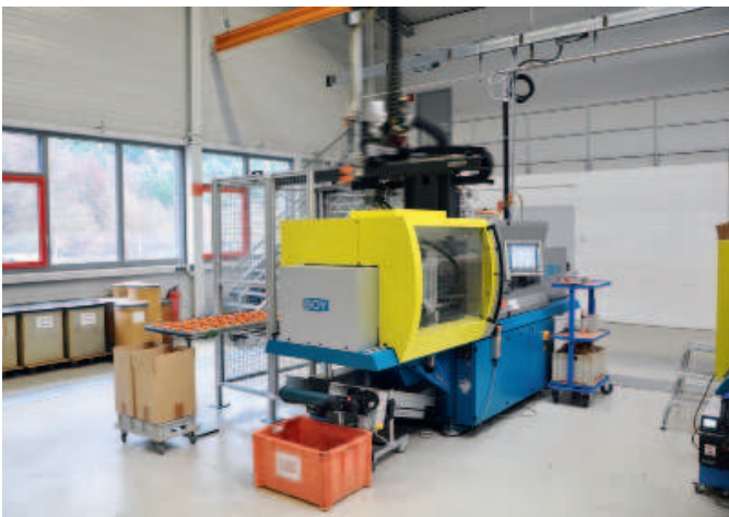
Boy 90 E mit Servoantrieb, 900 kN Schließkraft und 280,5 cm 3 Einspritzvolumen.
