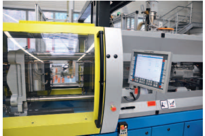
Boy 90 E mit Servoantrieb, 900 kN Schließkraft und 280,5 cm 3 Einspritzvolumen. Der angeschlossene Touchscreen zeigt die aufgebraachte Energie bei der Produktion.
