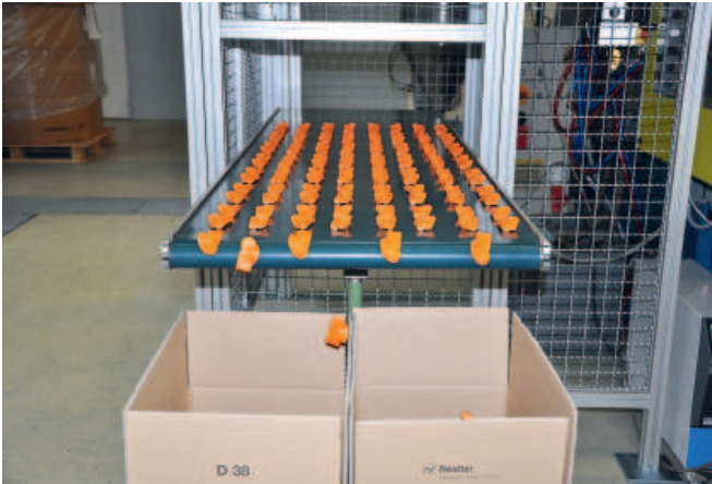
Testlauf für die Neuteil-Produktion eines Radsensorgehäuse für die Bremslektronik im Kfz. Fertigung aus 4-fach Form, vollautomatisierte Entnahme und formnestbezogene Ablage.
