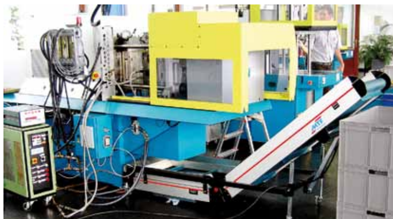
Nach mehrtägigen Versuchsreihen im Technikum des Spritzgießautomatenherstellers Boy war eine spezielle Maschinenkonzeption aus dem Boy-Standardbaukasten (basierend auf der Boy 55 A) für das Dünnwandtechnik-Projekt gefunden, die Fleig dann käuflich erworben hat
